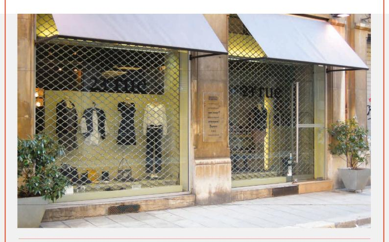
Réalisées en tubes ondulés en acier galvanisé de 14 mm de diamètre, les grilles à enroulement Tubonda S (Simple) et R (Renforcée) répondent parfaitement aux exigences de la sécurisation d'un magasin.
