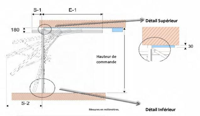
Ces portes peuvent s'automatiser avec un guide supérieur d'un maximum de 30 mm de hauteur pour assemblages au ras du plafond.
