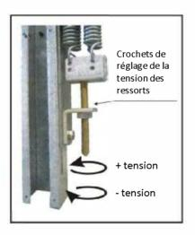
Système de réglage de la tension des ressorts de facile d'utilisation.
