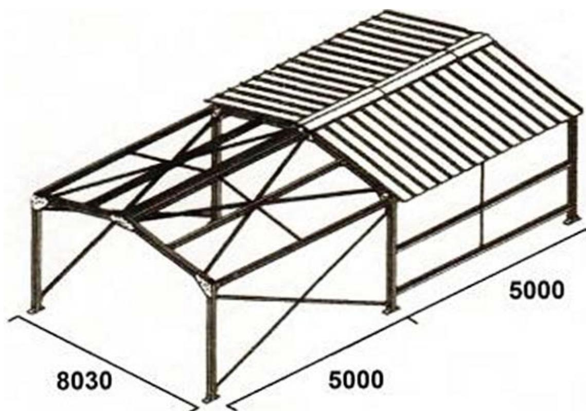
Pour le pré-montage des Fermes (F1) et des Poteaux (P1 et P2) utilisation des Boulons de 12/140
