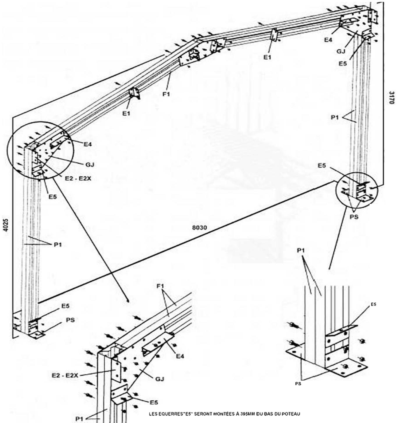
Pour le pré-montage des Fermes (F1) et des Poteaux (P1 et P2) utilisation des Boulons de 12/140
